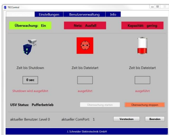
Die TECControl leitet den Shutdown ein
