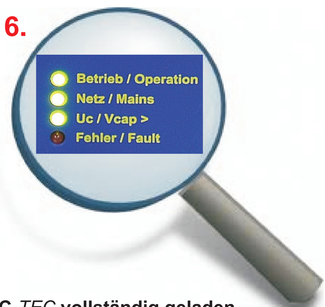
C-TEC vollständig geladen. Die LEDs „Betrieb/Operation“, „Netz/Mains“ und „U C /V cap >“ leuchten
