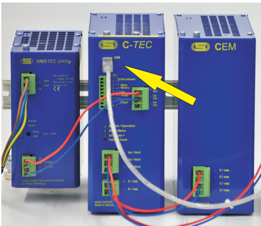
Anschluss der USB-Verbindung zum PC (falls am C-TEC vorhanden)
