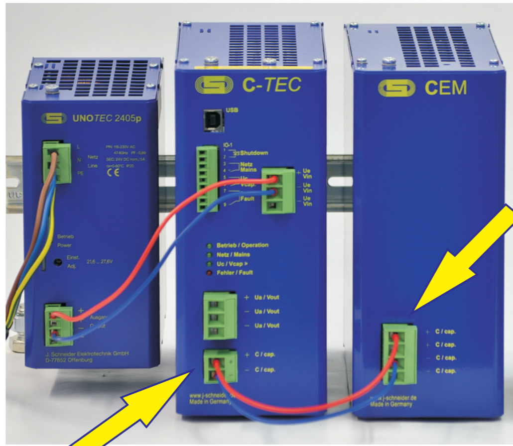
Anschluss des CEM an den Kondensatorausgang des C-TEC
