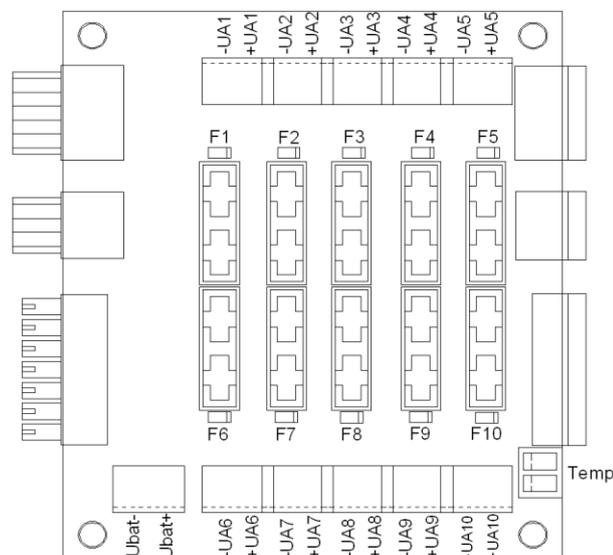
**Anmerkung:** Mit der neuen Generation der Sicherungsplatten (NBP21248G10001) gibt es nur noch **einen** Typ. Zur Erweiterung wird wiederum eine Sicherungsplatine des gleichen Typs verwendet.
