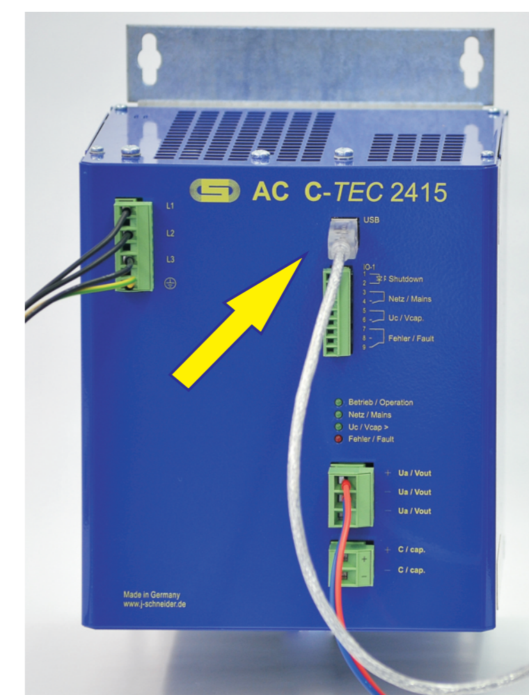
Anschluss der USB-Verbindung zum PC
