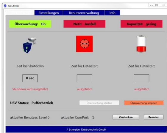
Die TECControl leitet den Shutdown ein
