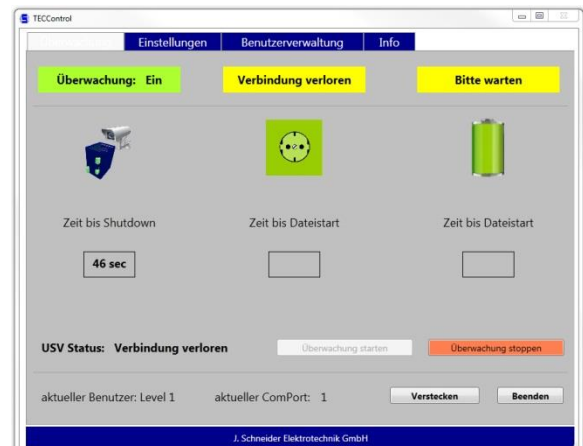
Verbindung zur USV verloren
